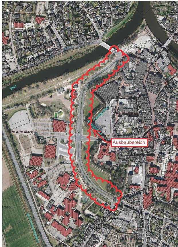
Geplant ist ein Ausbau als einseitiger Zweirichtungsradweg mit Gehweganlage auf gesamter Länge. Die Gesamtausbaubreite beträgt 5,25 m. Der Radweg wird auf 2,50 m verbreitert. Für die Herstellung des neuen Geh- und Radweges ist der Ausbau der bestehenden Pflasteroberfläche einschließlich der Einfassungen erforderlich.
