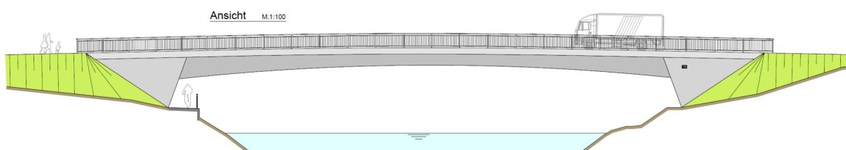
Das Bauwerk wird als integrales Einfeldbauwerk in Stahlverbundbauweise geplant. Der Überbau besteht aus einem 5- stegigen Plattenbalken mit variabler Konstruktionshöhe (1,25 m in der Feldmitte bis 2,25 m bei den
